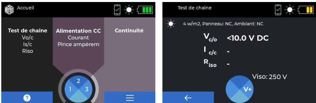
Séquence type affichant V_{o/c} , I_{s/c} et la mesure de la résistance d'isolation.
