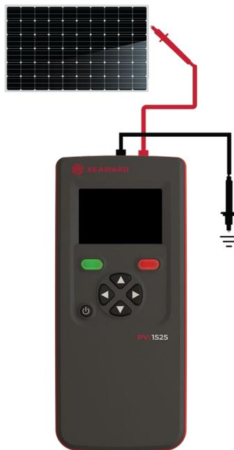
Mit der Isolationswiderstandsmessung kann der Benutzer die Isolation zwischen zwei Punkten mithilfe der roten und schwarzen Anschlüsse messen. Die Spannung wird an der roten Anschlüsse angelegt und über die schwarze Anschlüsse zurückgeleitet.
