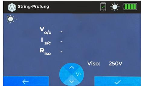
Eine typische Sequenz, die  $V_{o/c}$ ,  $I_{s/c}$  und die Isolationswiderstandsmessung zeigt.
