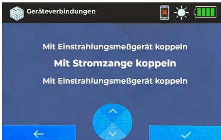
Die Geräteverbindungseinstellungen ermöglichen die Kopplung des drahtlosen Einstrahlungsmessers (SS:200LR) und der Stromzange (PV:1500).
