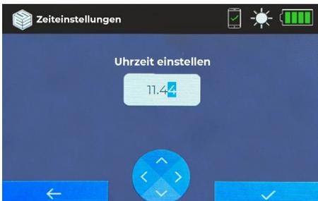
Datum und Uhrzeit sind werkseitig voreingestellt, können jedoch manuell geändert werden. Alternativ synchronisiert sich das Gerät automatisch mit der Uhrzeit des Mobilgeräts, wenn es mit der PV:Sync Mobile App verbunden ist.
